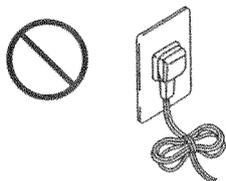
請不要割傷、加工、強力彎曲、拉扯、上壓重物或用尼龍綁帶及鐵絲捆綁。損壞後繼續使用有可能導致觸電·短路·引起火災。
