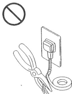
放置重物、加熱、拉扯所產生的破損，是火災及觸電發生的原因。
