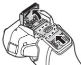
按住開鎖鈕 (a)，並將修剪器推桿向下滑至修剪器。
