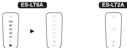
電池電量指示燈和充電狀態指示燈 (➡) 將亮起，並於 5 秒後熄滅。
