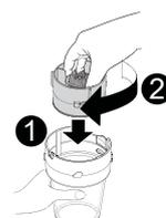
使用前,請確保乾磨杯墊圈無損傷並組裝到位。
