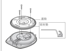
卸下三支螺釘,取下蓋殼,更換密封墊。
