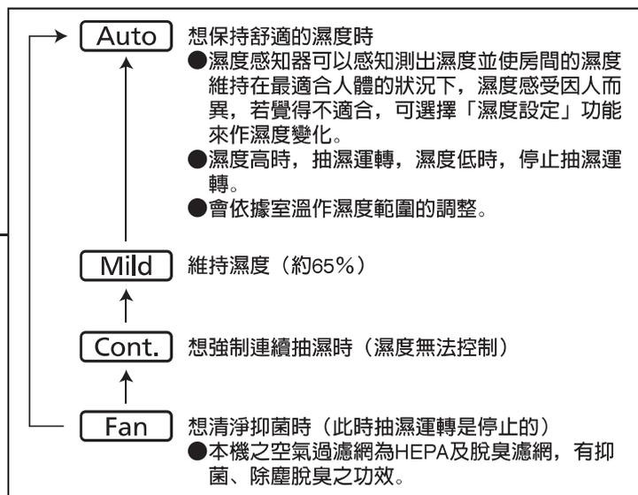
\* 當濾網檢知器檢測到有安裝 HEPA 集塵濾網時，按壓功能選擇鍵時 [Fan] 會同時亮起；若無安裝過濾網時，按壓功能選擇鍵，[Fan] 則不會同時點亮，僅單獨空氣清淨功能時，[Fan] 才會亮起。HEPA 集塵濾網未安裝時風速會作變化。
