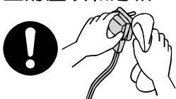
電源插頭上的塵埃會累積濕氣，導致電源插頭的絕緣層失去效用，可能導致火災或觸電。
