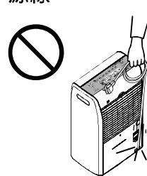
這樣可能會造成短路或損傷電線內部的導線，並可能導致火災或觸電。
