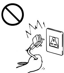
如果拉扯電源線有可能損壞電源線導致短路、火災或觸電。
