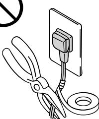
放置重物、加熱、拉扯所產生的破損，可能導致火災或觸電。
