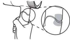
• إذا أصبح الهواء بارداً على نحو متكرر وفي حالة رؤية شرر في بعض الأحيان عند اندفاع الهواء الساخن من المجفف، فهذا يعني أن هناك أتربة متراكمة في مدخل و/أو مخرج الهواء أو أن مدخل الهواء مسدود بفعل شعرك أو يدك. (هذه الظاهرة ناجمة عن المفتاح الحراري في مجفف الشعر. إنه جهاز حماية. لا يمثل الشرر أي خطورة داخل الجهاز و/أو في نفسه.) حرك المفتاح الرئيسي إلى وضع "0" ثم قم بإزالة أي أتربة متراكمة.
