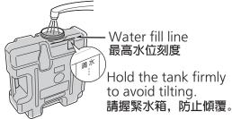
② Empty the drain tank. 倒掉排水水箱裡的水。
