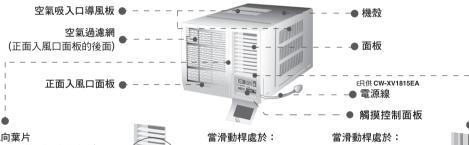
垂直風向葉片 (用於上下調整空氣流動方向)。 垂直送風調整板可用調整片控 制,使調整板能向上、向下或 向前排風
