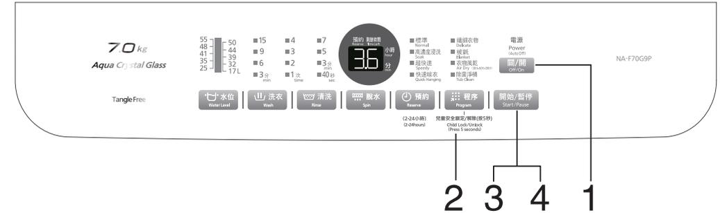
**1** Put the laundry in, and press the power OFF/ON button. 放入衣物，按下電源“關/開”鈕。
