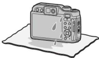
**4 確認沒有水滴，打開側蓋，用軟的乾布將內側殘留的水滴或沙子擦去。**
