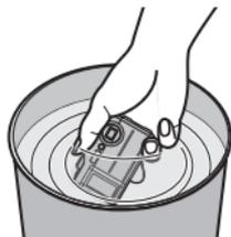
**2 上下倒置持拿本相機，以手心輕輕拍打相機，然後將圖中顯示的那一面朝下，用軟的乾布將水滴擦去。**
