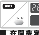
按下 TIMER(定時器)按鈕會顯示先前的溫度設置。同時 MODE (模式) 及 FAN SPEED(風量)指示燈將會亮起。此顯示會持續 5 秒，然後顯示屏會顯示剩餘時間。MODE(模式)及 FAN SPEED(風量)指示燈將會亮。
