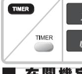
按 TIMER 鍵以檢查剩餘的編程定時器設置。數字將會顯示 5 秒鐘，然後自動地轉換回溫度設置。
