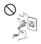
拉扯電源線有可能損壞電 源線導致短路、火災或觸 雷。
