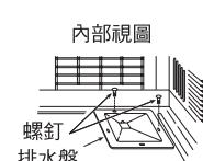
用兩個螺釘將排水盤安裝於機殼的右角。
