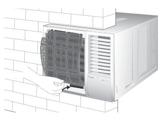
8 將串鉤插入進氣網的洞孔。
