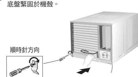
4 將底架放回機殼。然後用底盤鎖定支架及螺釘將底盤緊固於機殼。
