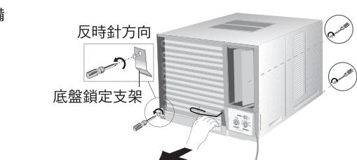
④ 請於安裝前、拆除機前、銅管旁、壓縮機旁及上部的避震器。同時也拆除纖維膠帶及連杆。(參考注意標簽)
