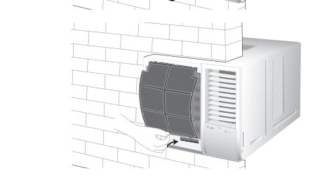
⑩ 將串鉤插入進氣網的洞孔。
