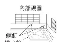
用兩個螺釘將排水盤安裝於機殼的右角。
