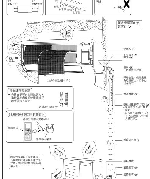
室內機實際上將採用不同的 (\*) 如需在機箱後部使用支架(請參閱"4室內機的安裝"欄)來支撐機組,則該距離應為 65 mm
