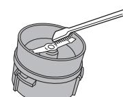
بعد از استفاده از آسیاب خشک، لطفاً قطعات آن به ویژه شیار و تنیع آسیاب را به موقع تمیز کنید. برای این منظور، واشر را بپروان بپارید و شیار و تنیع آسیاب را با استفاده از یک مسوک به دقت تمیز کنید. هرگز برای تمیز کردن دستگاه از آب استفاده نکنید.
