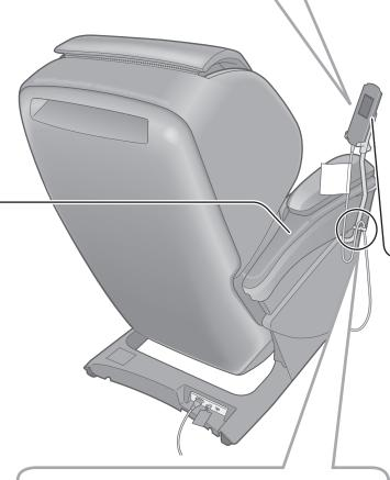
● 用夾子固定操作器線。 於固定時,不要使夾子下的電纜在靠背升起時過度鬆弛。 (以避免絆到腳)
