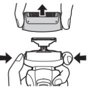
1. 依圖示，按著網層拆除按鈕並向上提起外層網面部分。
