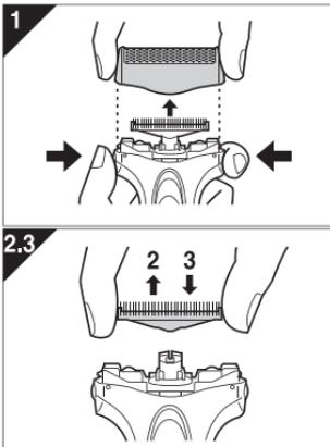
1. 依圖示，按著網層拆除按鈕並向上提起外層網面部分。
