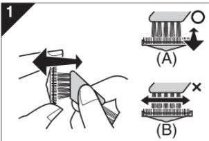
1. 利用短刷依著 (A) 方向來清潔內層刀片。利用長刷來清潔外層網面、刮鬍刀機身及修剪器。
