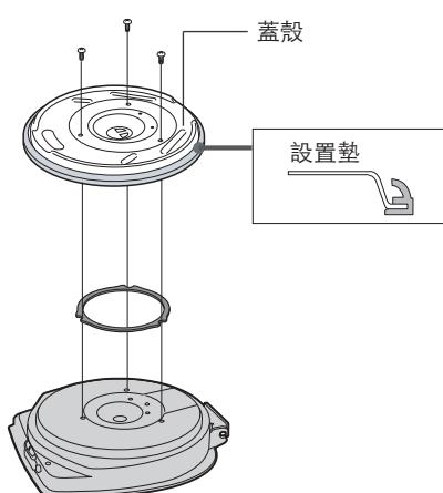
卸下三支螺釘，取下蓋殼，更換密封墊。再把蓋殼裝上，扭緊螺釘。
