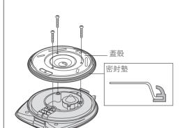
卸下三支螺釘,取下蓋殼,更換密封墊。
