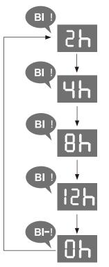
2 hours timer 定時2小時 Stop operation automatically after 2 hours. 2小時後自動停止運轉。
