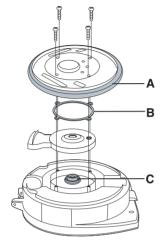
卸下四支螺釘,取下蓋殼,更換密封墊。
